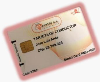
O Smart Card, **reconhece o condutor**, controlando tempo de trabalho e descanso, estabelece velocidade máxima para cada condutor na unidade instalada e permite gerar o scoring de conduta da sua maneira de conduzir. Esta se personaliza para cada empresa e condutor. Agregando o Leitor Biométrico se gera uma segurança maior da presença do condutor.
